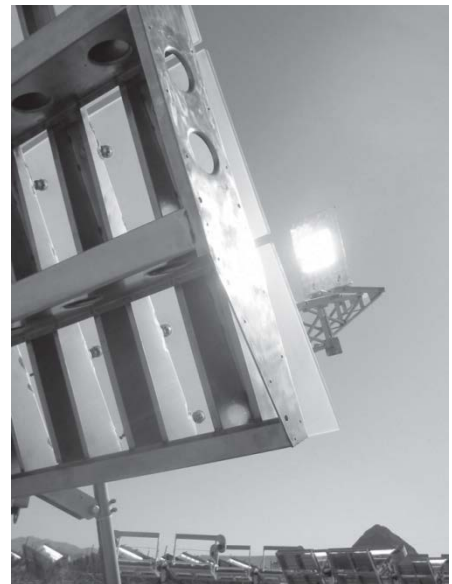
Figur 5: Reflekterende facetter, kollektorstruktur og fokuseret stråle i målområdet.
