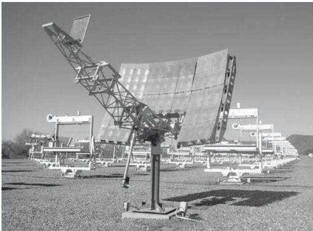
Figur 1: Testsystem til ultraaccelereret vejrpåvirkning (UAWS), opstillet i Arizona.
