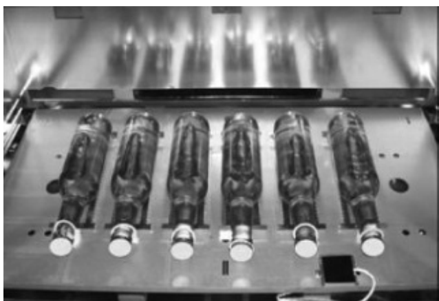
Figur 1: Xenon-teknologi udfører accelererede fotostabilitetstest ved realistiske betingelser. Prøvekommeret har "flatbed" (til venstre SUNTEST® XXL+) og en karrusel (til højre, Xenotest® Beta+).
