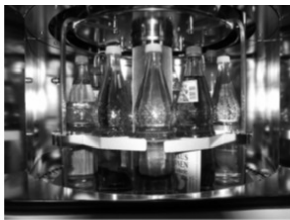
Figur 1: Xenon-teknologi udfører accelererede fotostabilitetstest ved realistiske betingelser. Prøvekommeret har "flatbed" (til venstre SUNTEST® XXL+) og en karrusel (til højre, Xenotest® Beta+).
